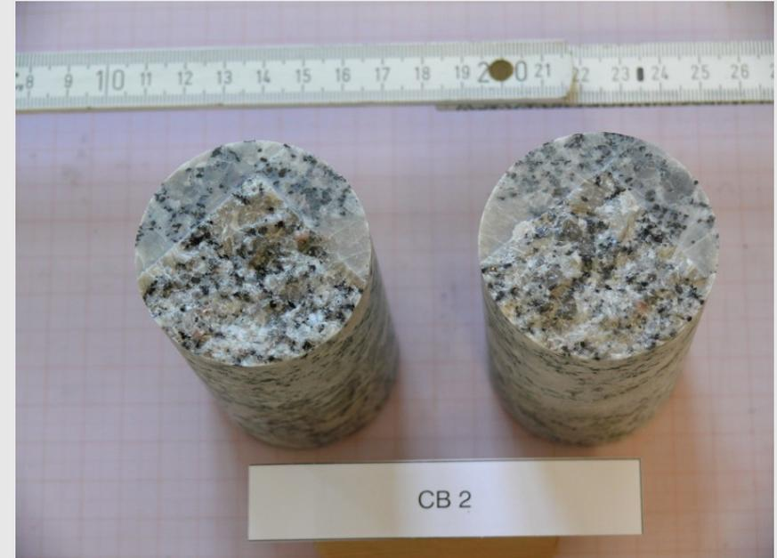
Probendurchmesser: ~50 mm, Probenhöhe ~200 mm
