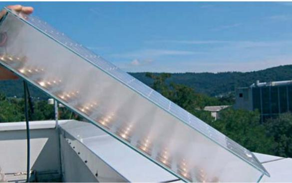
FLATCON®-Modul als Beispiel für ein konzentrierendes Photovoltaik-Modul. Durch Rauch wird die Bündelung der Lichtstrahlen visualisiert.
