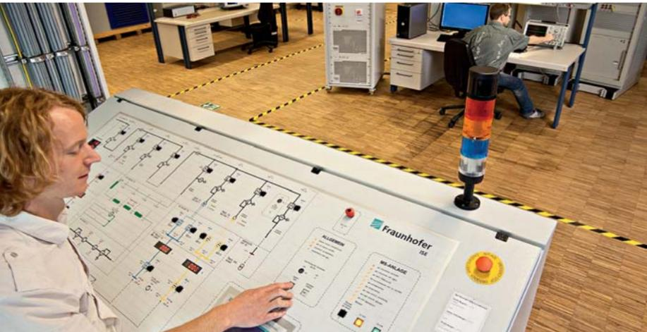
Steuerpult für die „Low Voltage Ride Through“-Prüfeinrichtung zum Test von Wechselrichtern nach der neuen Mittelspannungsrichtlinie. Quelle: Fraunhofer ISE
