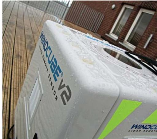
Das kastenförmige LiDAR-Windmessgerät misst die Windgeschwindigkeit per Laserstrahlen, die für Menschen unsichtbar aus dem oben angebrachten runden Fenster ausgesendet werden.
