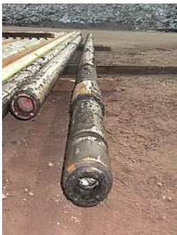
Einsatzbereites und abgenutztes Bohrgestänge
