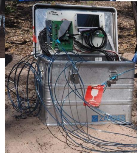
Bodengasprobenehmer mit angeschlossenen Bodengaslanzen, Monitor und der Steuerplatine(rechts).
