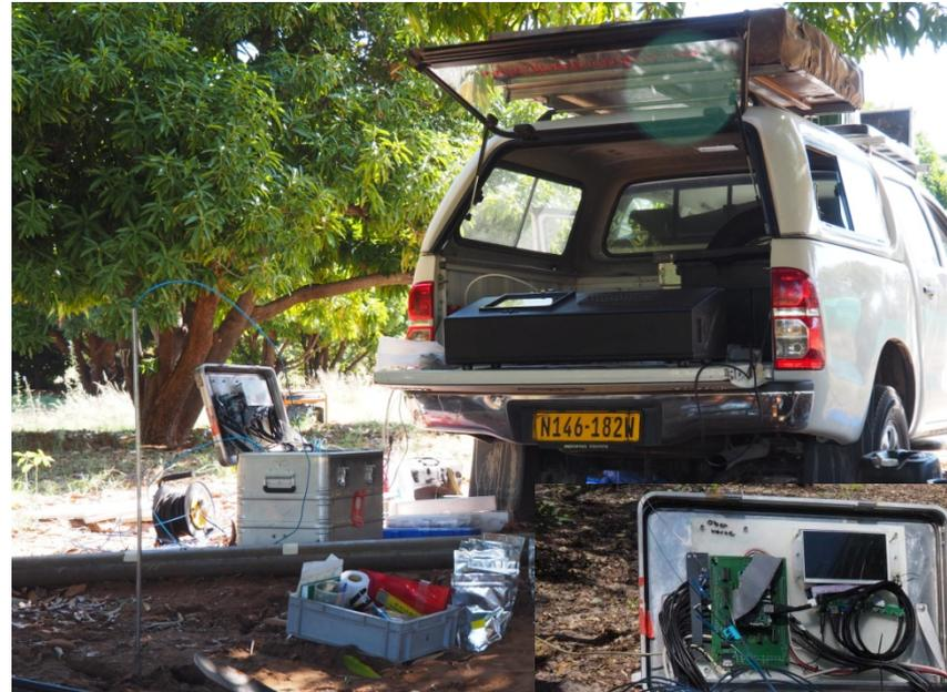
Feldaufbau der Messpartur mit dem Laserspektrometer im Laderaum des Pick-up Geländewagens (oben).
