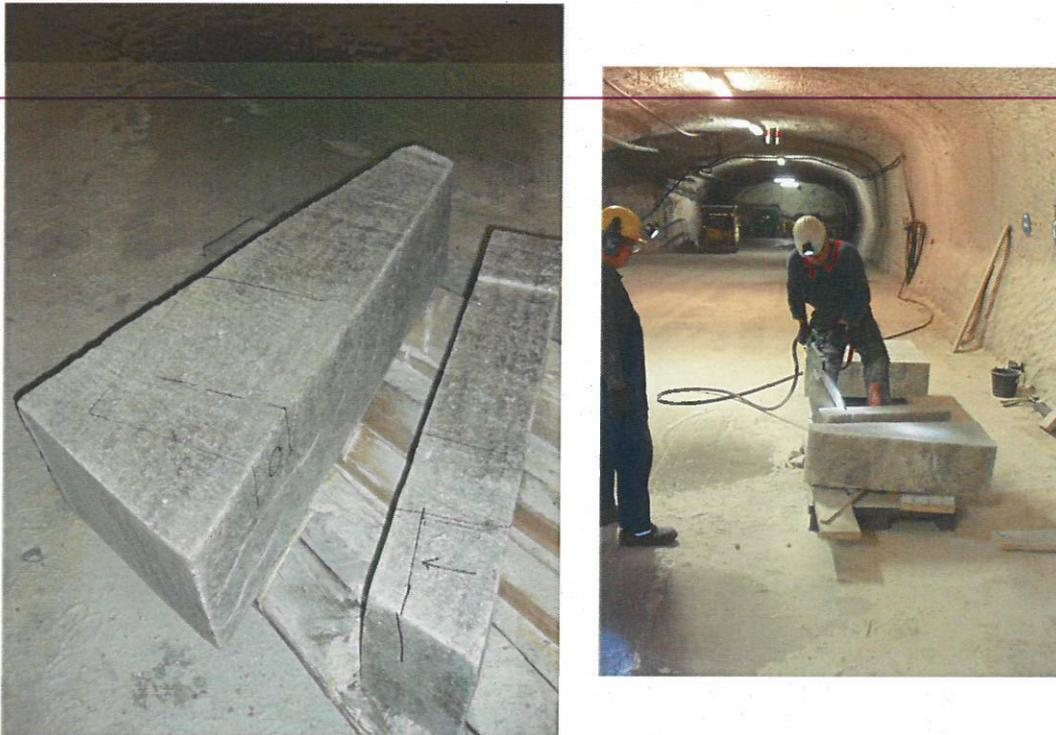
Abb. 2-3. Herstellung der Rohprüfkörper bzw. Probenwürfel. (li.) auf der Seite liegendes Teilsegment des Großblocks mit steilstehender Schichtung. (re.) manuelle Zerlegung des Teilsegments in Rohprüfkörper.
