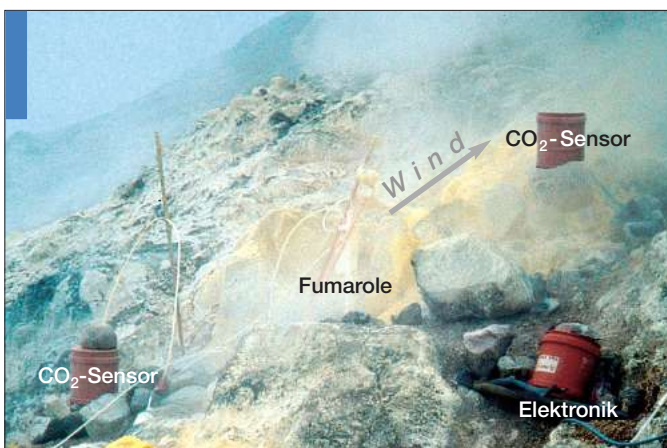
Installierte BGR-Messinstrumente an einer Fumarole des Galeras.
