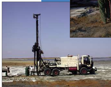
Probenahme bis zu 25 m Tiefe durch den Bohrtrupp des Geologischen Dienstes Botswana.
