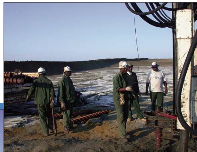
Probenahme bis zu 25 m Tiefe durch den Bohrtrupp des Geologischen Dienstes Botswana.
