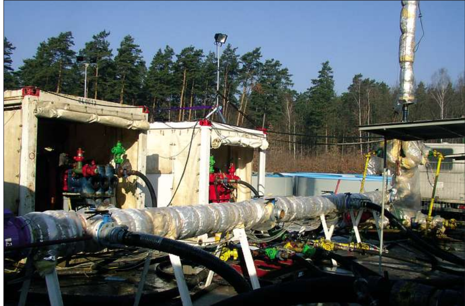
Hochdruckpumpen, Saugmanifold und Bohrlochkopf bei den Stimulationsexperimen- ten an der Bohrung Groß Schönebeck im Januar/Februar 2003.
