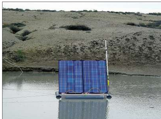
Die BGR-Monitoring-Station auf dem Dashgil-Schlammvulkan fängt auf einem See aufsteigendes Gas ein und misst u. a. die zeitlichen Variationen der Gasaufrate aus dem Untergrund.
