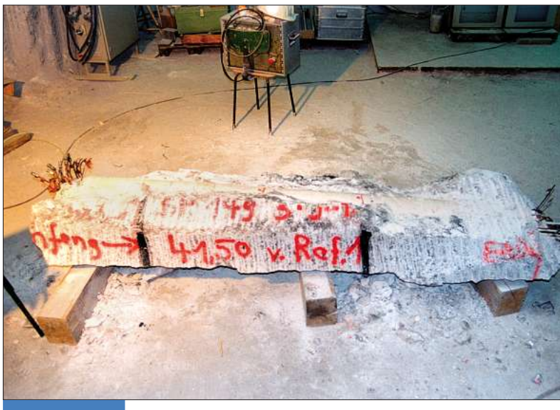
Wiedergewinnung einer im Salzgebirge einzementierten Spannungsmonitorstation nach über zehn Jahren.
