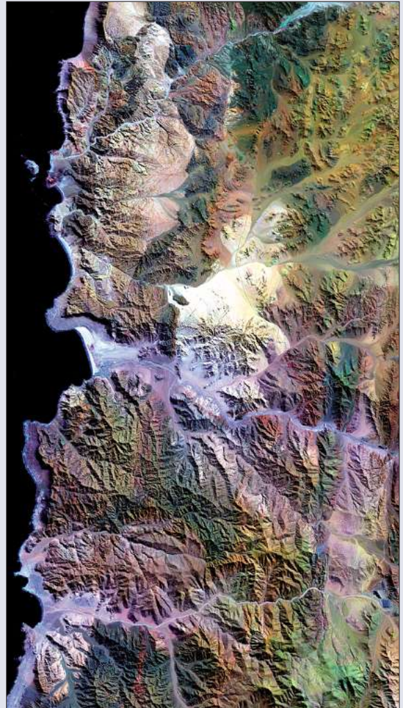
Flotationsabgänge der Kupfermine Salvador der staatlichen chilenischen Bergbaugesellschaft „Corporacion Nacional del Cobre de Chile“ (CODELCO), 1100 Kilometer nördlich von Santiago. Bergbaualllasten der über Jahrzehnte ins Meer eingeleiteten Abgänge der Mine führten zur Verlandung großer Flächen mit zum Teil kontaminiertem Material. (Satellitenaufnahme: Landsat 7, BGR)
