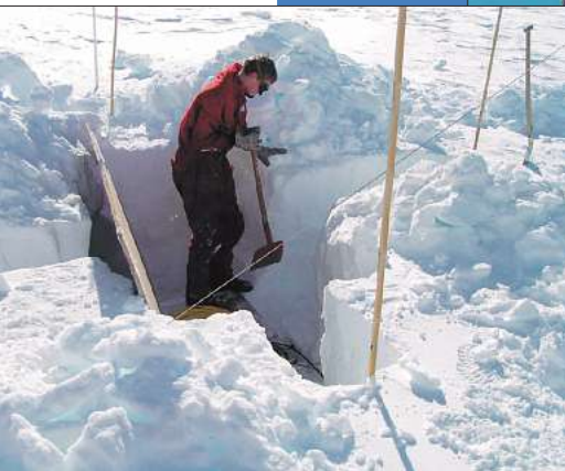
Ausgraben einer von neun Infraschallstationen aus dem Eis nach einer Betriebszeit von einem Jahr und Neuinstallation an der Oberfläche.
