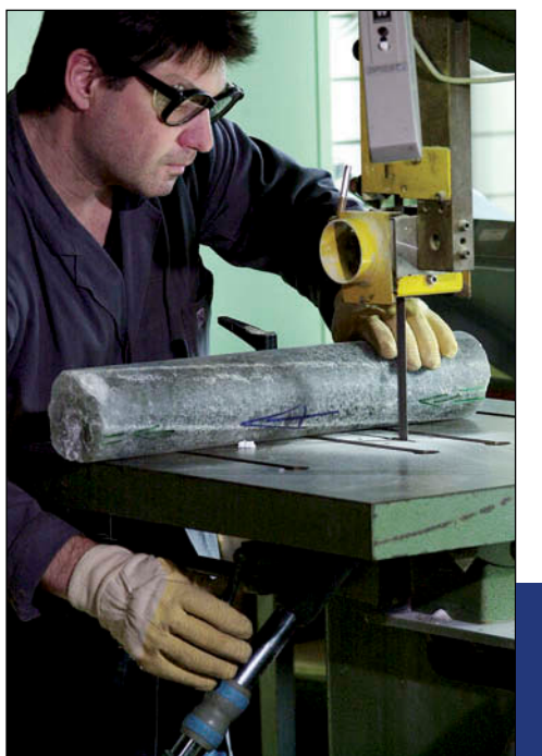
Prüfkörperherstellung, hier Ablängen der Bohrkern mit der Bandsäge.
