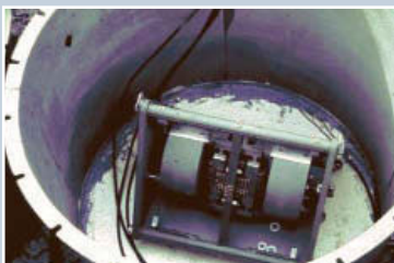
Oben: Konfiguration des analogen GRF-Arrays. Oben rechts: ursprünglich auf Film aufgezeichnete Seismometerdaten. Oben links: Datenerfassungszentrale des GFS-Array in einem Container. Links: Benioff Seismometer zur Registrierung der horizontalen Bodenbewegung.
