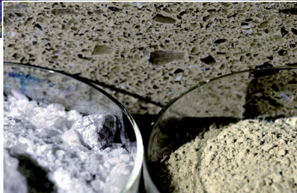
Salzgrus und Bentonit vor und nach (in den Schalen) Kompression in einem Oedometerversuch (oben).
