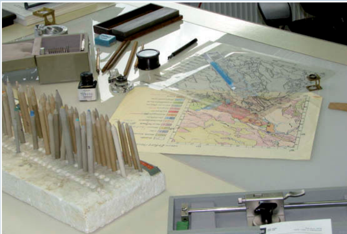
Oben: Typischer analoger Kartographen-Arbeitsplatz. Zeichenfedern, Retusche-Schaber, Tuschenäpfe und Schleifstein gruppieren sich um die Zeichenfolie. Daneben liegt das von Hand mit Buntstift gefertigte Kolorit.
