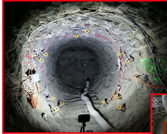
Blick in die Zwillingnischen des CD-A-Experiments. Untersucht werden hydraulisch-mechanische Effekte durch Auffahrung und Bewetterung in der offenen Nische (links) und durch Auffahrung bei größtmöglicher Vermeidung von Austrocknung in der geschlossenen Nische (rechts).
