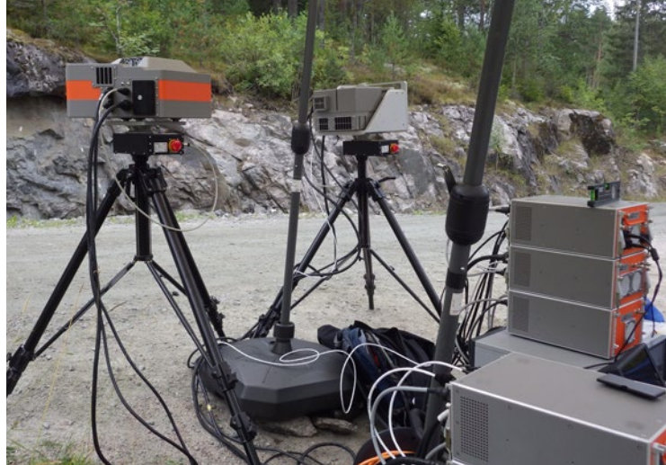
Spektrale Messungen am Gesteinsaufschluss mit BGR-Systemen (links). Einsatz eines Geländespektrometers zur punktuellen Messung lithologischer Einheiten (rechts).
