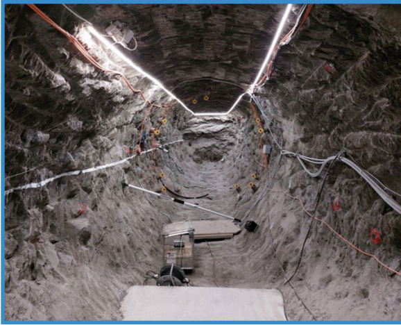
Blick in die Zwillingnischen des CD-A-Experiments. Untersucht werden hydraulisch-mechanische Effekte durch Auffahrung und Bewetterung in der offenen Nische (links) und durch Auffahrung bei größtmöglicher Vermeidung von Austrocknung in der geschlossenen Nische (rechts).
