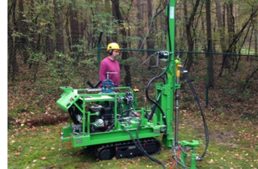
Bohrung zur Untersuchung der Eisensulfid-Gehalte.
