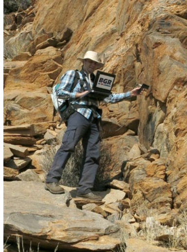
Spektrale Messungen am Gesteinsaufschluss mit BGR-Systemen (links). Einsatz eines Geländespektrometers zur punktuellen Messung lithologischer Einheiten (rechts).
