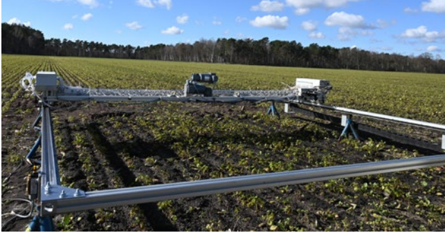
Die Beregnungsanlage zum Aufbringen von markiertem Stickstoff (links) wird im Feld eingestellt (rechts).
