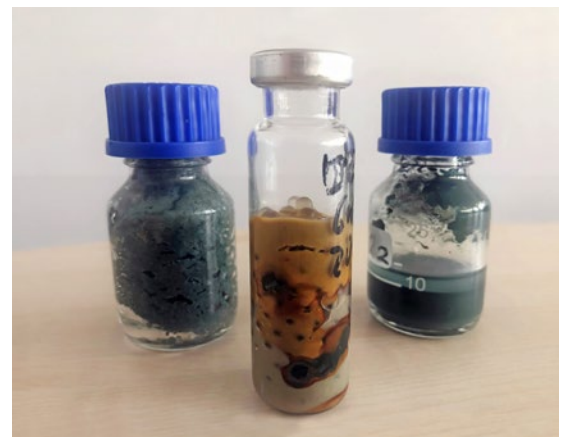
Laborproben zur Eisenkorrosion sowohl unter Einfluss von Sauerstoff (Mitte) als auch ohne Sauerstoff (links und rechts).
