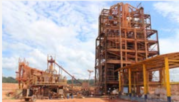
Erzaufbereitungsanlage mit Spiralseparatoren im Zinnbergwerk Santa Bárbara von Estanho de Rondônia SA (ERSA).
