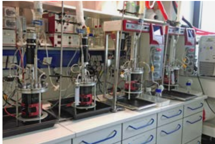
Biolaugung von Kupfer in Rührreaktoren im Geomikrobiologie-Labor der BGR.
