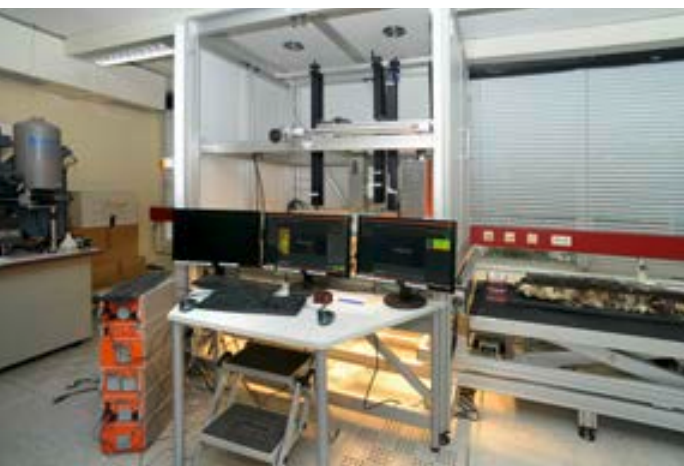
Hyperspektral-Laborscanner „SisuROCK“ zur reflexions-spektroskopischen Charakterisierung von Gesteinsproben.
