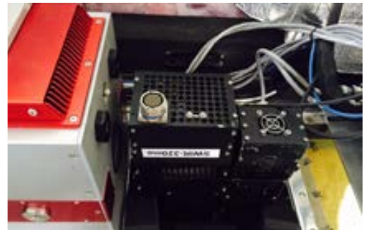
Eingesetzte Sensorik während der flugzeuggestützten Hyperspektralbefliegung in Südafrika. Neben den Hyperspektralkameras wurde auch noch ein LIDAR System, zur Generierung eines hochauflösenden Geländemodells eingesetzt.
