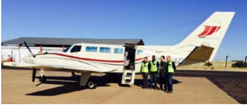
Die Hyperspektralbefliegung wurde mit einem Kleinflugzeug des Typs Cessna 404 durchgeführt. In dem Flugzeug wurden vier Fernerkundungs-Sensoren verbaut.
