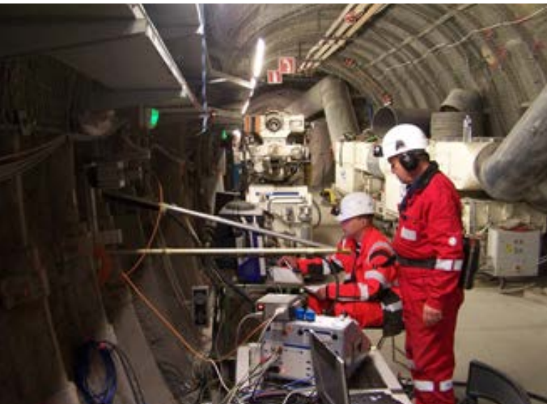
Seismische Messungen im Tongestein im untertägigen Forschungslabor (Frankreich).
