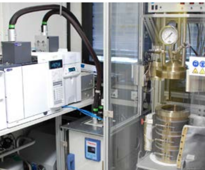
Ein Hochdruckreaktorsystem mit daran angeschlossenen Analysegeräten zur Untersuchung der Umwandlung organischen Materials in Gesteinskernen.
