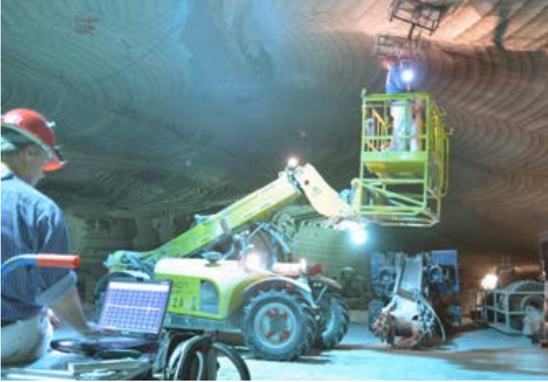
Elektromagnetisches Reflexionsverfahren der BGR zur Erkundung einer Salzstruktur.
