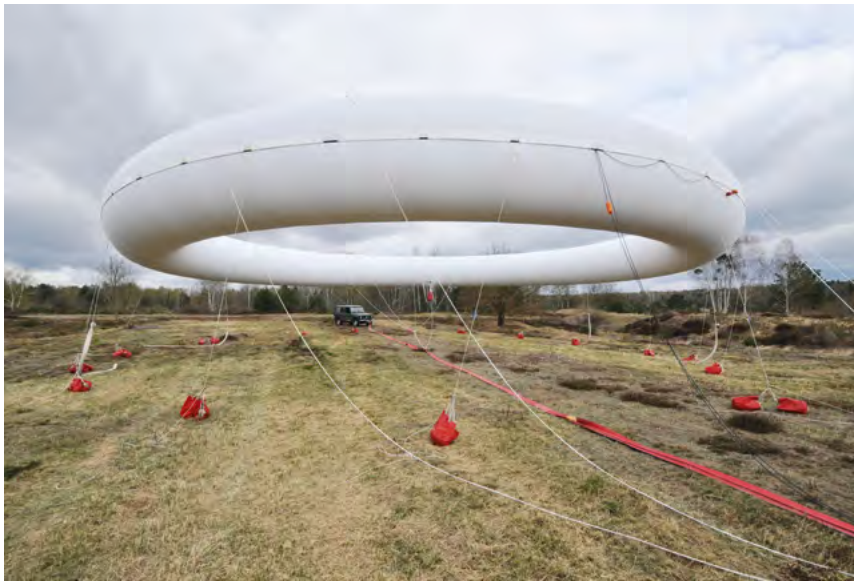
▲ Die Spule zur Messung der Kernspinresonanz des Grundwassers bewegt sich mithilfe des Ballons schwebend durch das Untersuchungsgebiet.
