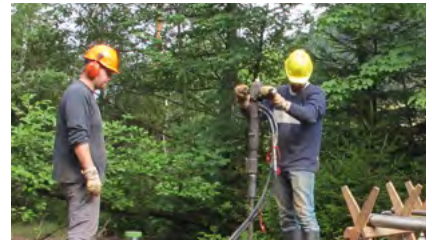
▲ Gewinnung von Bohrkernen mittels Rammkernsondierung auf der Pochsandhalde in der Nähe von Clausthal-Zellerfeld im Harz.
