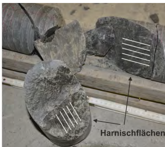
▲ Eine Störungszone im Tonstein unter dem Elektronenmikroskop (l.) und im Bohrkern (r.). An den Harnischflächen kann die Bewegungsrichtung abgelesen werden.
