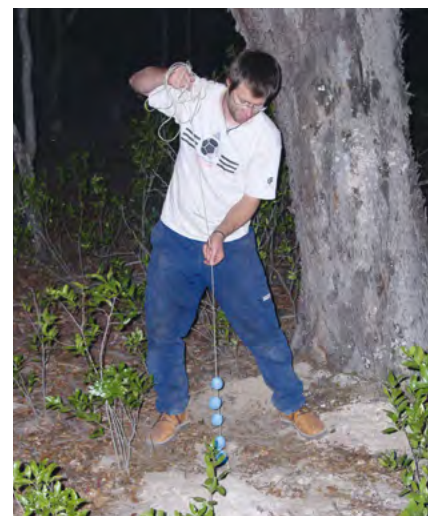
▲ Einbringen von Deuterium in den Boden mittels kleiner Wasserballons als künstliche Markierung.
