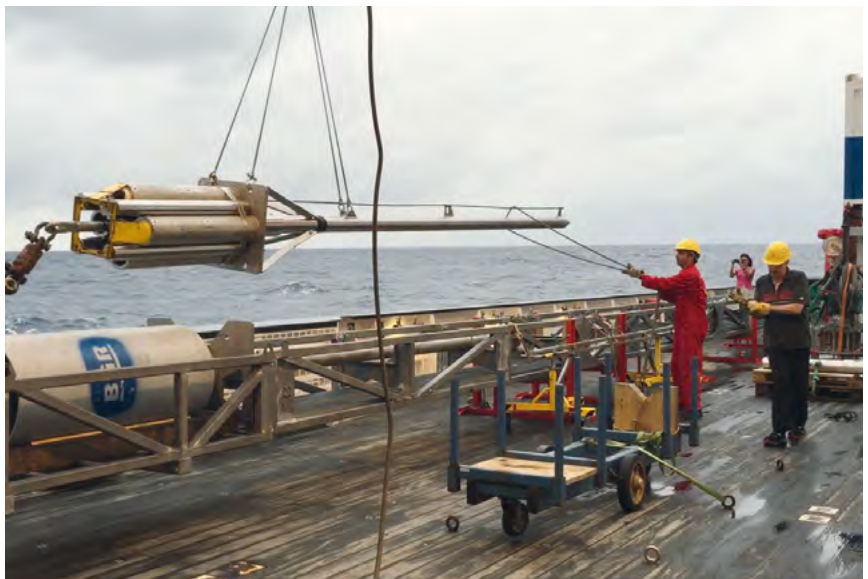
▲ Aussetzen einer Sonde zur Messung des Wärmestroms in Tiefseesedimenten während der Expedition SO-240.
