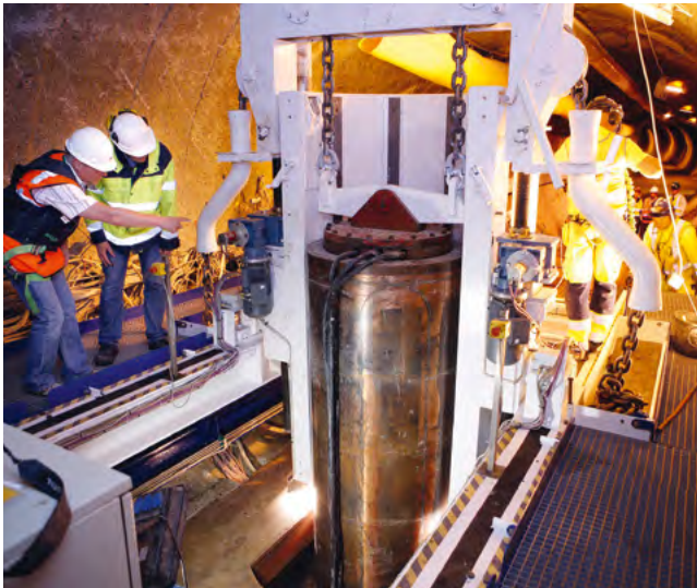
▲ Mitarbeiter des schwedischen Unternehmens SKB bringen die Dummy-Behälter für den Einlagerungsversuch von radioaktiven Abfällen im untertägigen Versuchstunnel im schwedischen „Äspö Hard Rock Laboratory“ in Position.
