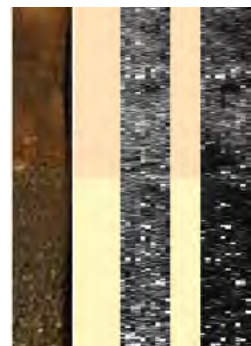
▲ Foto eines Bohrkernausschnittes der untersuchten Pochsandhalde (l.). Die Rückstände beinhalten sowohl feines (Ton-Schluff, orange) als auch grobes Material (Sand-Kies, gelb). Daneben sind die zugehörigen LIBS-Elementverteilungsbilder von Blei (Mitte) und Silber (r.) zu sehen.
