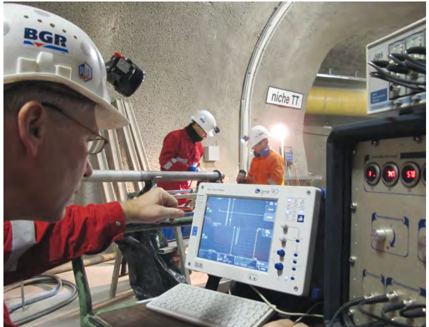
▲ BGR-Wissenschaftler im Felslabor Mont Terri in der Schweiz. Mit hochauflösenden, geophysikalischen Messmethoden ergründen sie, ob Tonstein für die Endlagerung hoch radioaktiver Abfälle geeignet ist.
