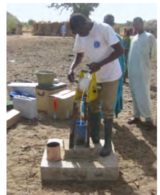
▲ Der Grundwasserspiegel wird über eine Messstelle ermittelt.
