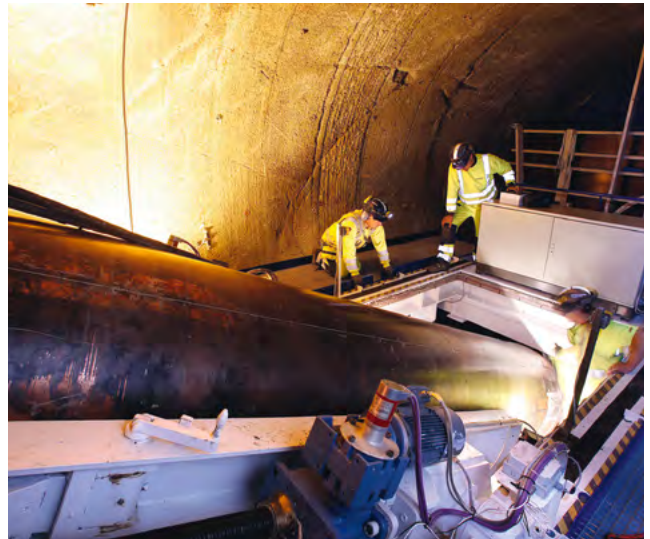
▲ Mitarbeiter des schwedischen Unternehmens SKB bringen die Dummy-Behälter für den Einlagerungsversuch von radioaktiven Abfällen im untertägigen Versuchstunnel im schwedischen „Äspö Hard Rock Laboratory“ in Position.
