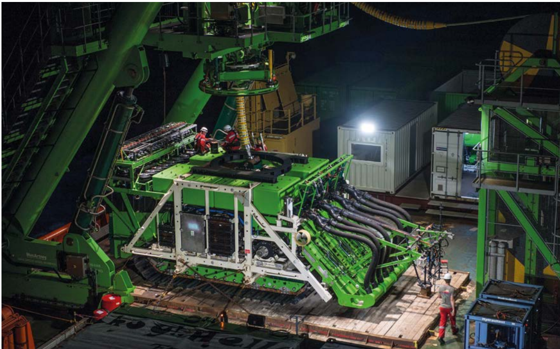
Abb. 2: Der Knollenkollektor-Prototyp „Patania II“ an Bord des durch GSR gecharterten Schiffes MV „NORMAND ENERGY“ (Foto: © GSR).
