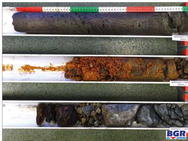
Abb. 7: Bohrkernproben, die mit dem neuen Bohrgerät ROCS in einem Massivsulfidfeld des Lizenzgebietes gewonnen wurden.
