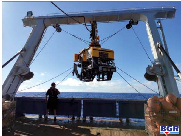
Abb. 6: Bergung des Tauchroboters ROPOS nach erfolgreichem Einsatz auf dem Forschungsschiff PELAGIA im Indischen Ozean.
