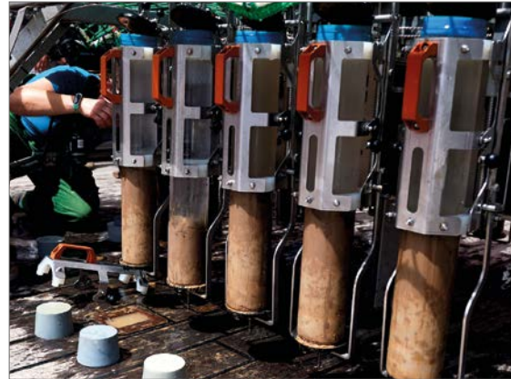
Abb. 5: Beprobung von Oberflächensediment mittels Multicorer für geochemische und biologische Analysen während der Fahrt SO295 auf FS „SONNE“ in November 2022 (Foto: Tim Kalvelage).
